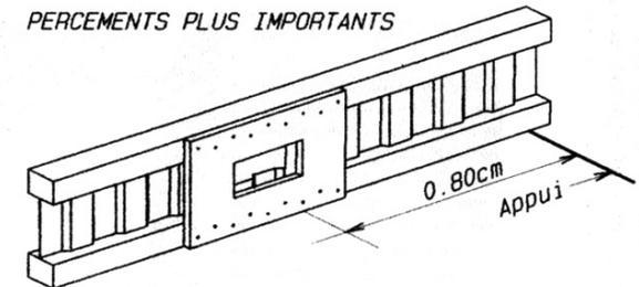
MINI a 0.80m de l'appui. et d'une DIMENSION INFÉRIEURE au 2/3 de la hauteur de l'âme acier Renforcés d'un CP de longueur égale a 3 fois la diagonale du trou.
