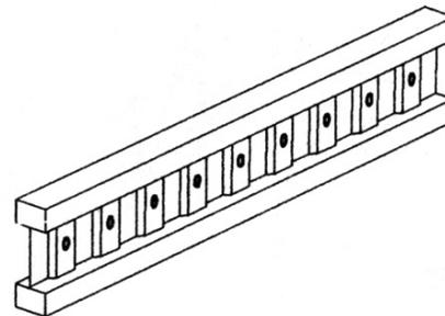
L'âme Acier des Poutres **Arba** est pré-stampée au centre de sa Ht. Faire sauter la Pastille par un simple choc permet le passage de petites gaines
